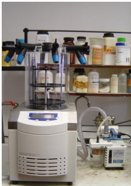
Slika 2. Liofilizator Christ Alpha 1-2 LD PLUS
