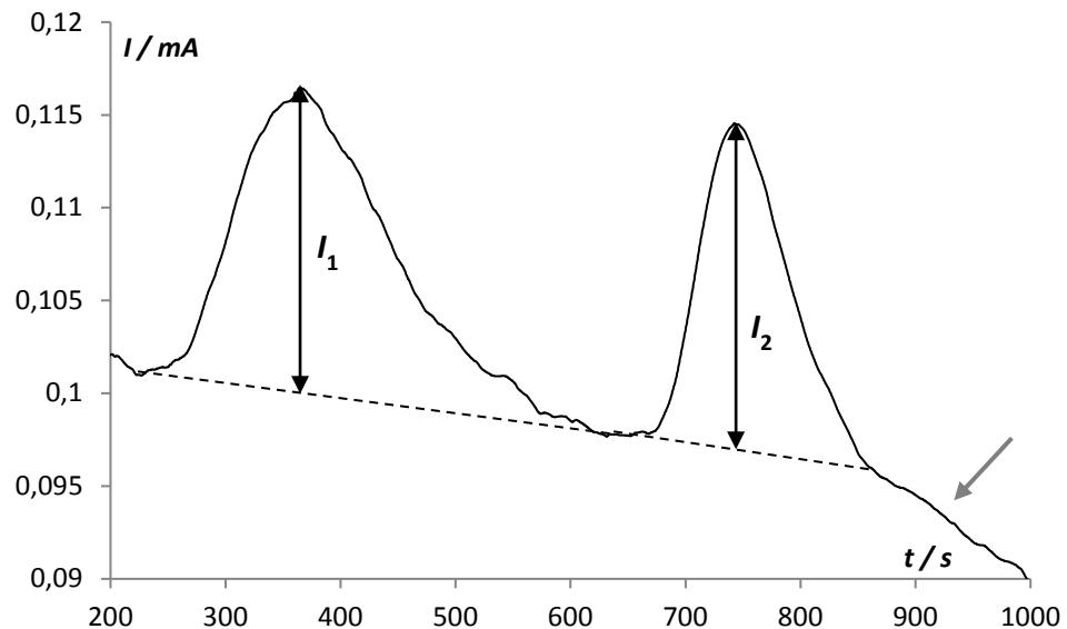
**Slika 7.** Strujni odziv senzora prilikom dvokratnog dodatka standarda sulfita ( $\gamma(\text{Na}_2\text{SO}_3) = 200 \text{ mg/L}$ ) pri pH osnovnog elektrolita od 6,0.
