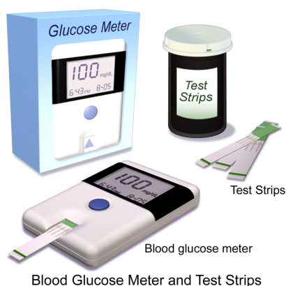
Slika 4. Standardni senzor za određivanje glukoze u krvi temeljen na primjeni papirnate mikrofluidike i elektrokemijske detekcije, preuzeto iz [10].
