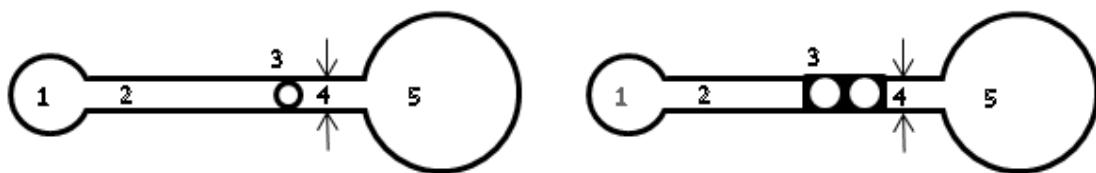
**Slika 5.** Shematski prikaz dizajniranog papirnatog mikrofluidičkog senzora. 1 – rezervoar osnovnog elektrolita, 2 – mikrofluidički kanal, 3 – difuzijska ćelija (s jednim ili dva elementa za nanošenje uzorka), 4 – elektrode, 5 – rezervoar za prihvata elektrolita.
