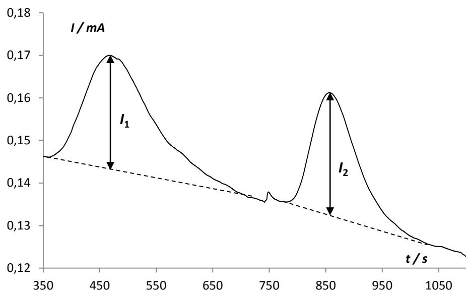
**Slika 8.** Strujni odziv senzora prilikom dvokratnog dodatka standarda sulfita ( $\gamma(\text{Na}_2\text{SO}_3) = 200 \text{ mg/L}$ ) pri pH osnovnog elektrolita od 9,2.
