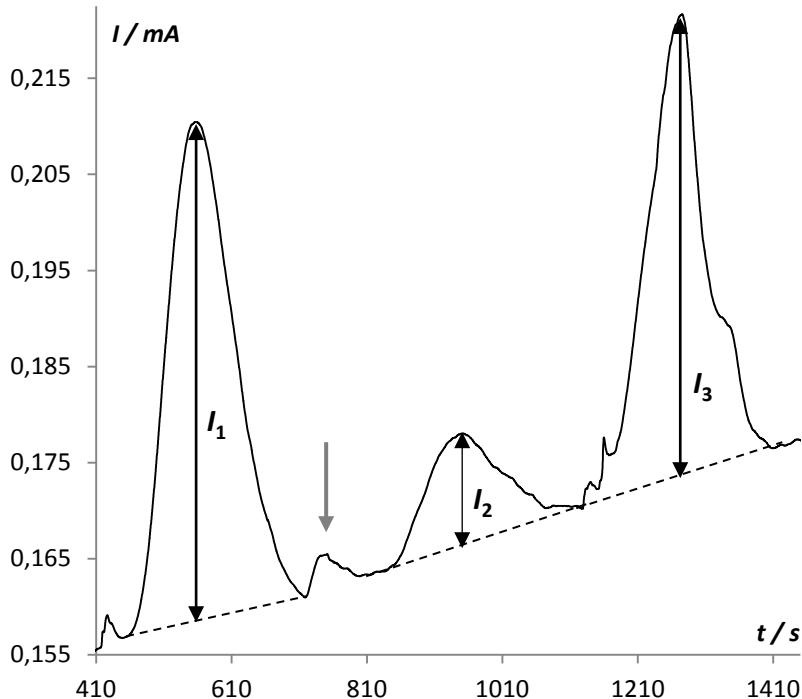
**Slika 10.** Strujni odziv senzora prilikom dvokratnog dodatka standarda sulfita ( $\gamma(\text{Na}_2\text{SO}_3) = 300 \text{ mg/L}$ ) na prvi element za dodavanje uzorka (odzivi  $I_1$  i  $I_3$ ) te drugi element za dodavanje uzorka (odziv  $I_2$ ).
