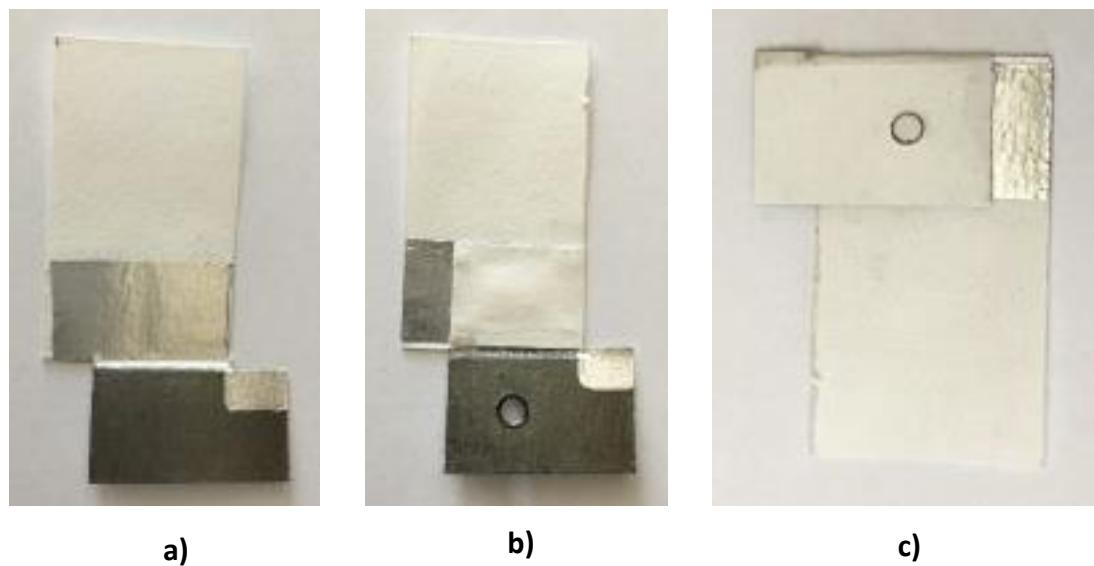
**Slika 8.** Izgled konstruiranog galvanskog članka na papiru sa a) izrađenim elektrodama, b) deponiranim katodnom smjesom i papirnatim separatorom na aluminijskoj katodi te c) u potpunosti sklopljen članak.
