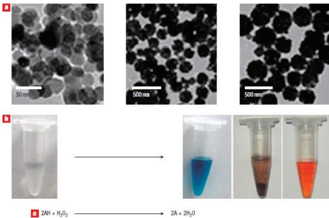
**Slika 3.** Elektronska mikrografija nanočestica Fe<sub>3</sub>O<sub>4</sub>, koje efikasno kataliziraju oksidaciju tetrametilbenzidina i ABTS-a s vodikovim peroksidom, mehanizmom sličnim mehanizmu peroksidaze. Preuzeto i prilagođeno iz [20].
