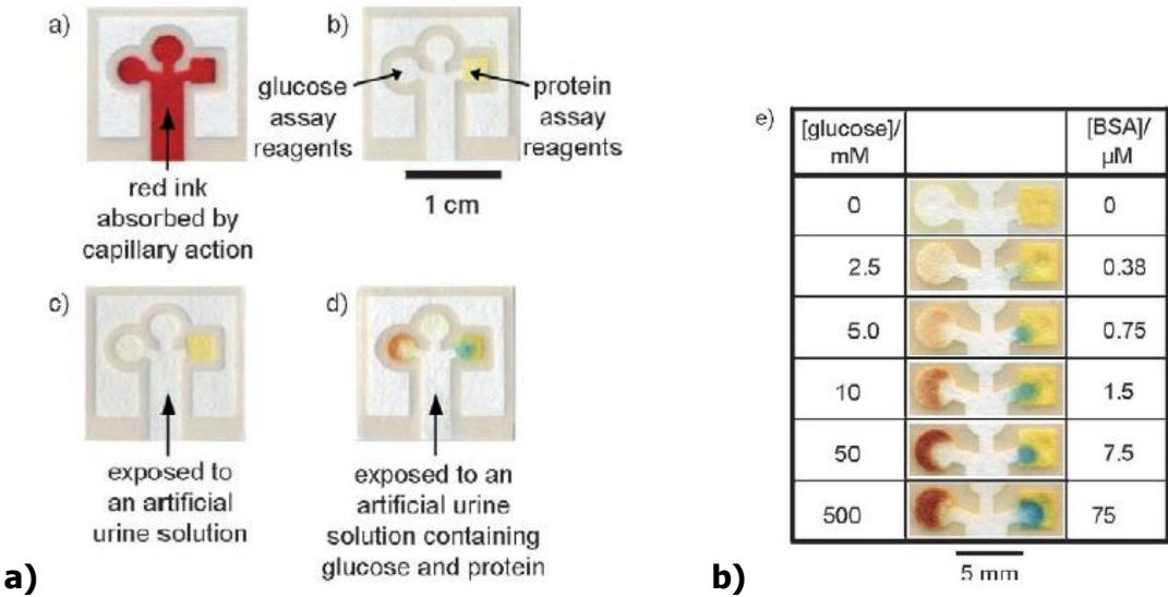
**Slika 2.** Uređaj za analizu koncentracije glukoze i proteina u mokraći. Na slici pod a) prikazano je djelovanje mikrofluidičkog uređaja, a na slici pod b) razine obojenja pri različitim koncentracijama glukoze, odnosno proteina. Preuzeto i prilagođeno iz [10].
