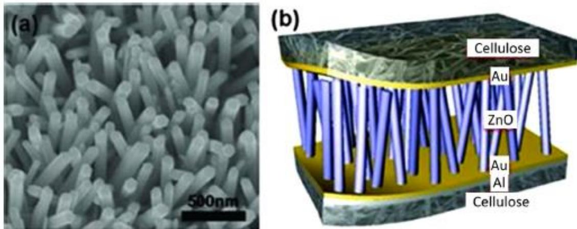
**Slika 5.** Papirnati piezoelektrični nanogenerator. Pod a) su prikazane ZnO nanocjevčice na celuloznoj podlozi, a pod b) shematski prikaz integriranog nanogeneratorskog uređaja. Preuzeto i prilagođeno iz [36].
