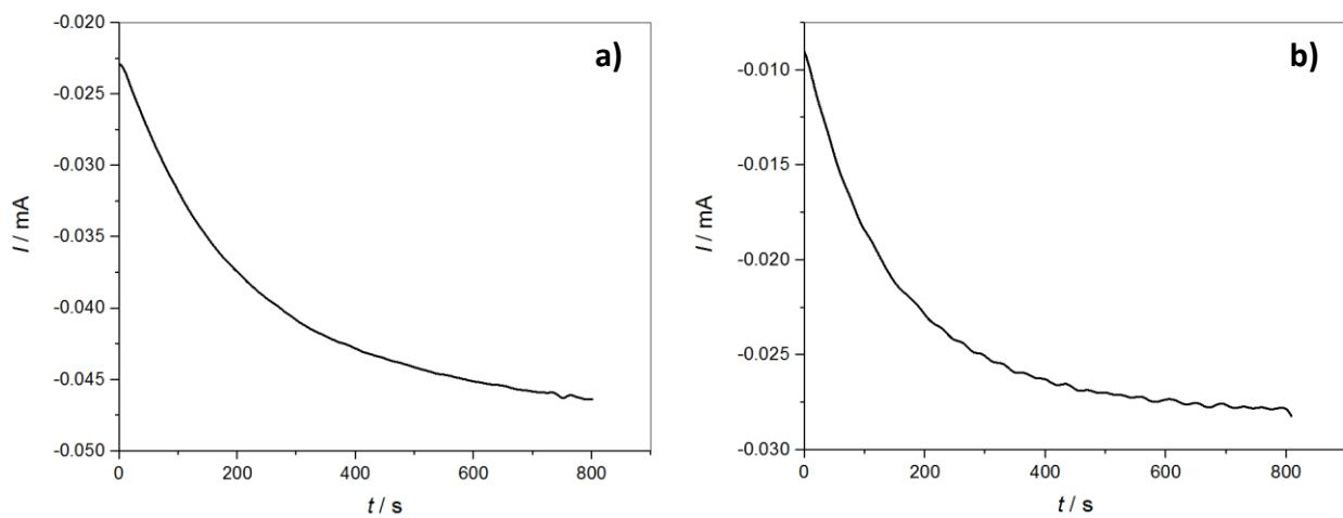
**Slika 7.** Kronoamperometrijske krivulje redukcije ABTS radikala nastalog tijekom oksidacije 2 mM ABTS-a vodikovim peroksidom, katalizirane željezovim(II) ftalocijaninom, u prisutnosti 15 mg/mL uree, pri pH a) 2.2 i b) 4,0.
