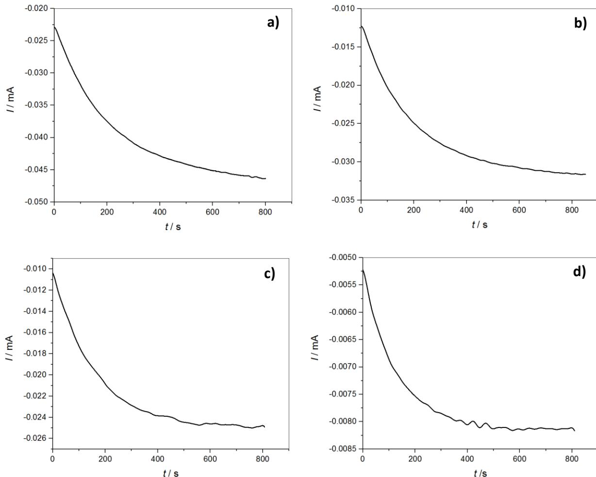
**Slika 6.** Kronoamperometrijske krivulje redukcije ABTS radikala nastalog tijekom oksidacije
