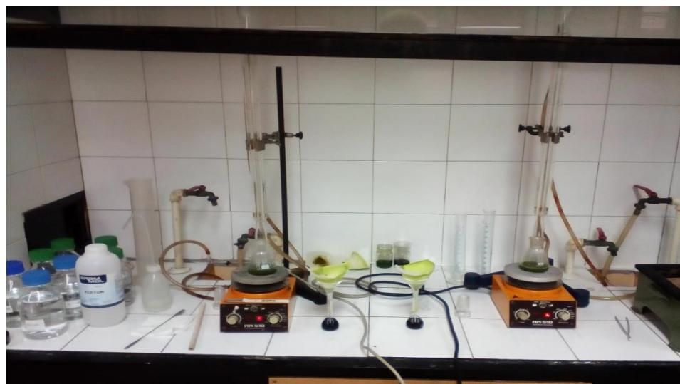
Slika 6. Ekstrakcija refluksiranjem (vlastita fotografija)
