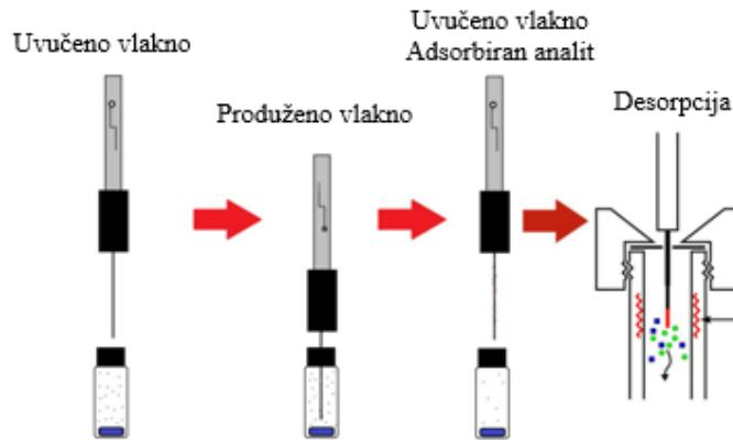
vlakno. Na ovaj način punilo vlakna dolazi u kontakt s prostorom iznad uzorka (eng. *headspace*) te se potpomognuta miješanjem, vrši adsorpcija hlapljivih sastojaka na polimerno vlakno. Nakon 60 minuta vlakno je uvučeno u iglu, te je igla kroz PTEF čep izvučena iz uzorka.
