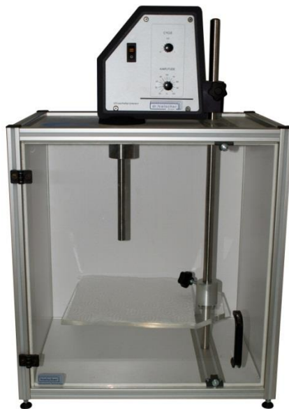
Slika 7. Uređaj za obradu ultrazvukom visokog intenziteta (Laboratorij za tehnološke operacije, Prehrambeno-biotehnološki fakultet Sveučilišta u Zagrebu, 2017)
