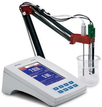
Slika 12. Digitalni pH-metar
