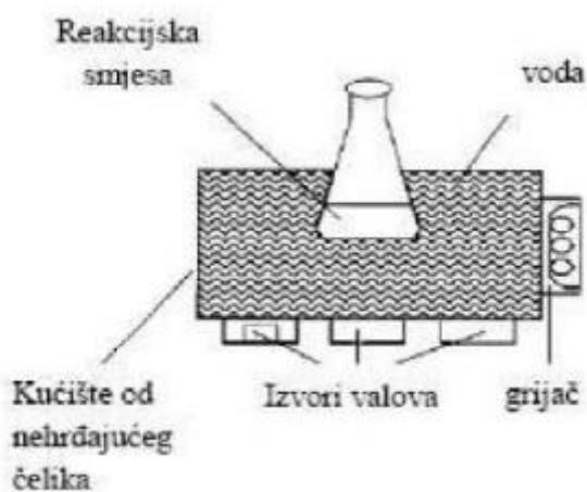
Slika 5. Ultrazvučna kupelj
