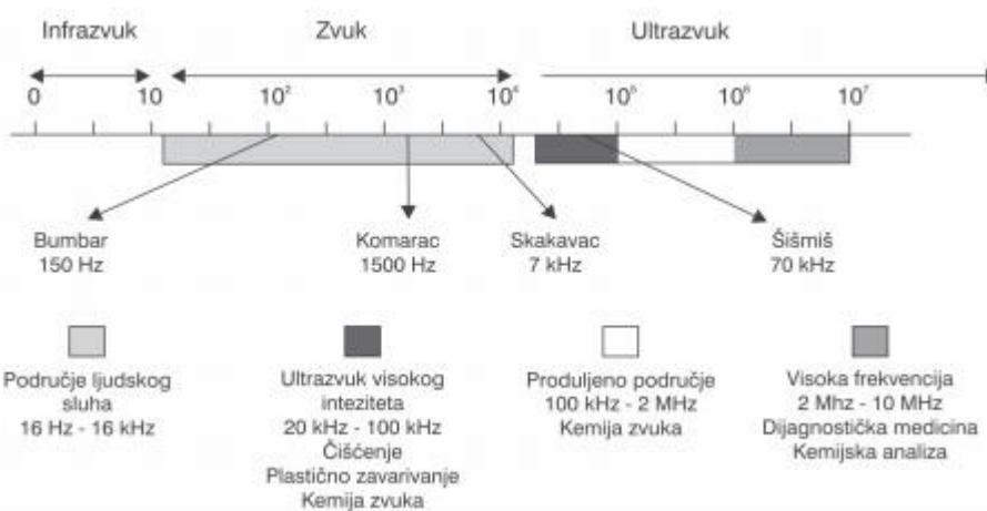
Slika 1. Spektar zvučnih frekvencija (Mason, 1998).
