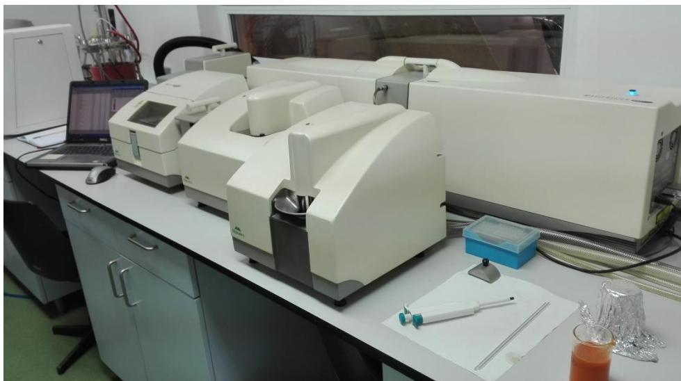
Slika 14. Uredaj Mastersizer 2000 sa vanjskom jedinicom Hydro 2000S (Malvern instruments, Worcestershire, UK)
