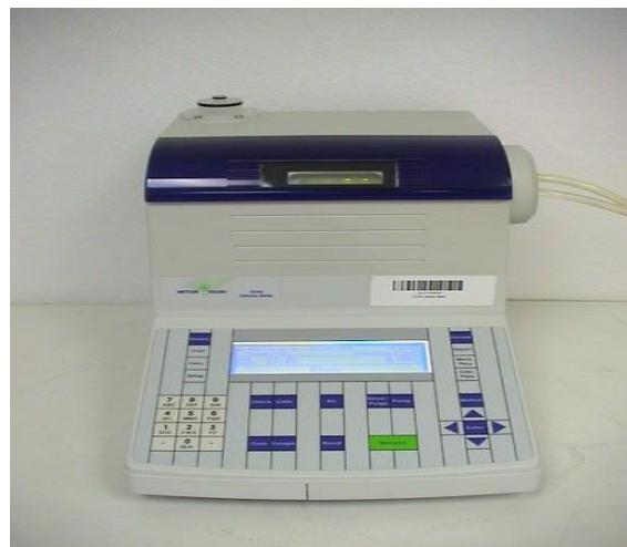
Slika 11. Uređaj za mjerenje gustoće „Mettler Toledo Density Meter DE 40“
