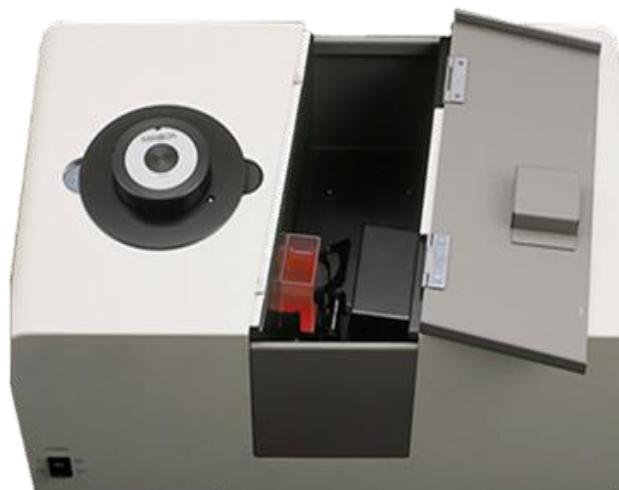
Slika 13. Spektrofotometar „Konica-Minolta CM-3500-d, Japan“
