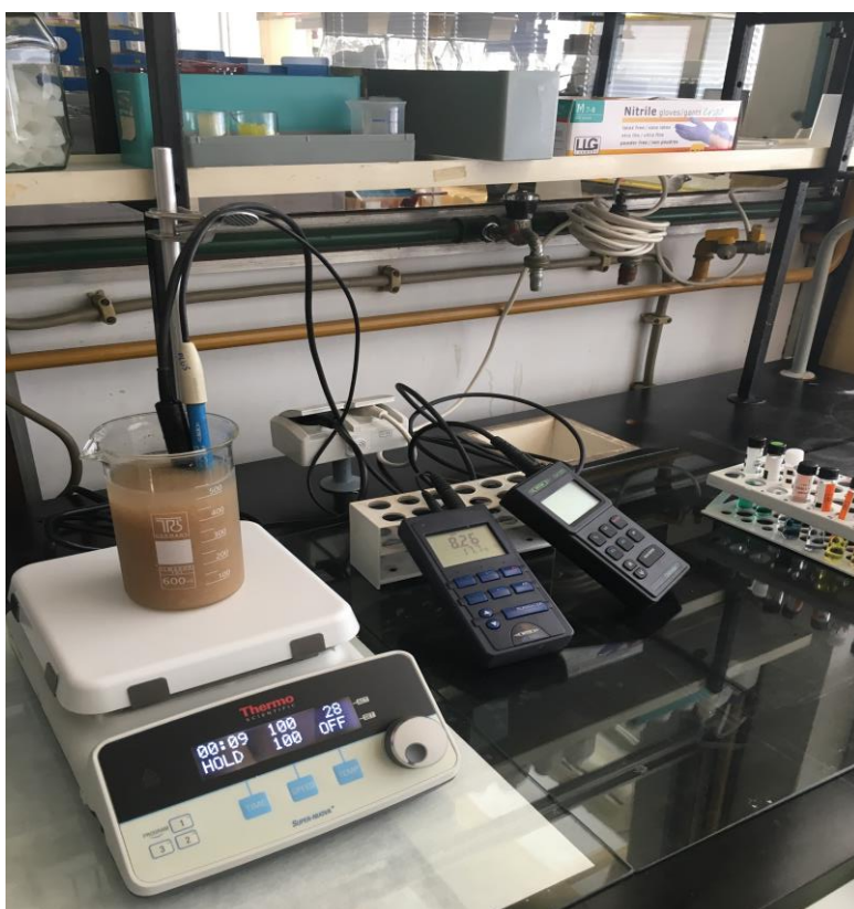
Slika 2. Izgled pokusa denitritirajuće defosfatacije u anoksičnim uvjetima
