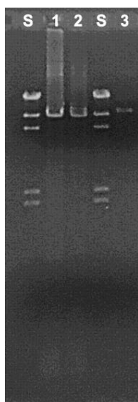
Slika 3. Provjera uspješnosti lančane reakcije polimerazom. Jažica S (standard) – DNA bakteriofaga \lambda pocijepana endonukleazom HindIII; 1 – PCR produkt 1 nastao korištenjem originalne otopine plazmida pSP-YAP1; 2 – PCR produkt 2 dobiven korištenjem razrijeđenog plazmida pSP-YAP1; 3– plazmid pSP-YAP1 pocijepan endonukleazom EcoRV.
