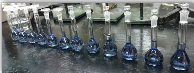
Slika 4. Uzorci ekstrakata kore mandarine priređeni za spektrofotometrijsko određivanje ukupnih fenola. 1
