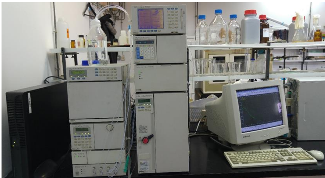
Slika 7. Shimadzu CLASS-VP LC-10AVP sustav za kromatografiju (Shimadzu, Kyoto, Japan) (vlastita fotografija)
