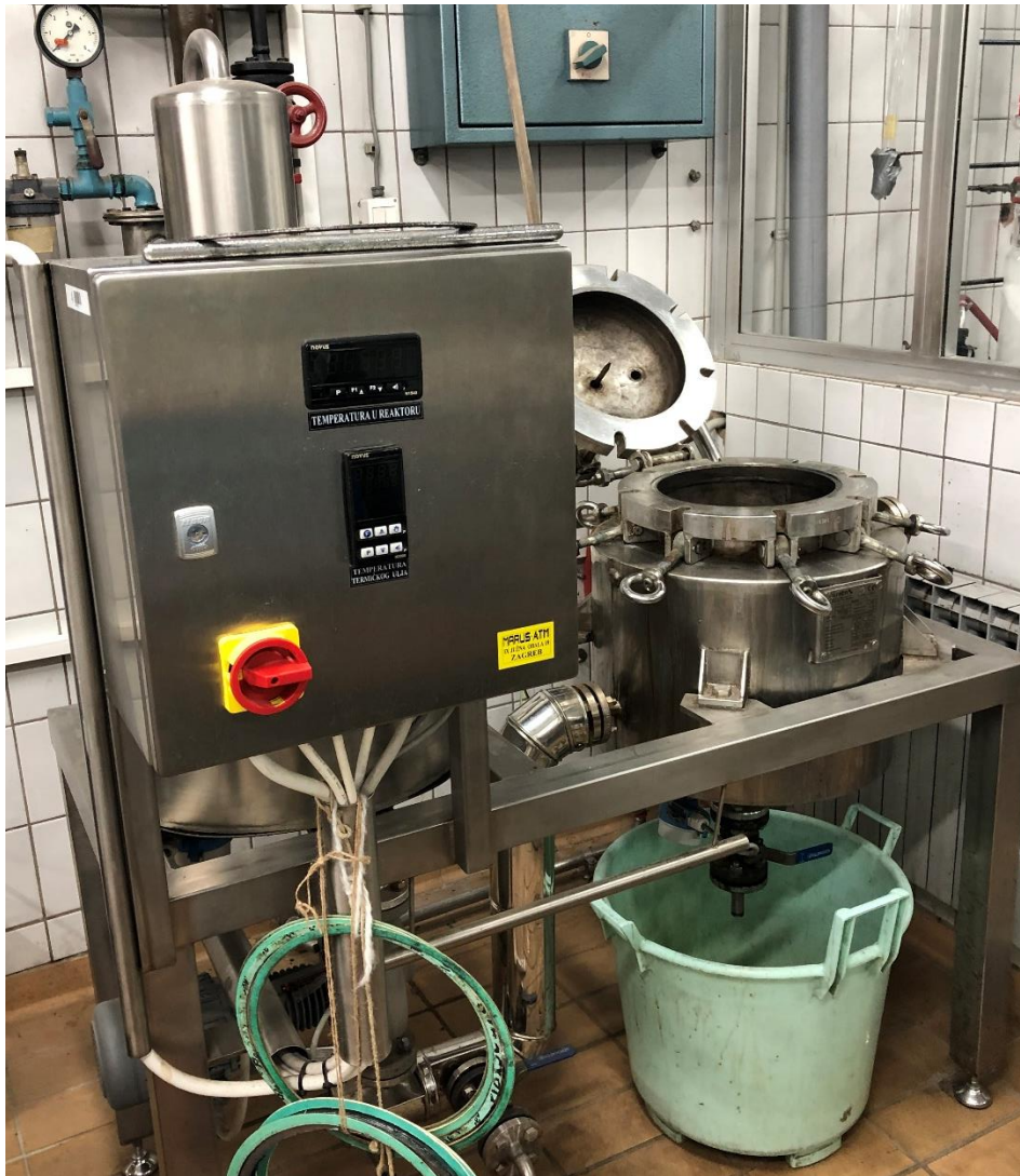
Slika 10b. Fotografija visokotlačnog reaktora za obradu lignoceluloznih sirovina.
