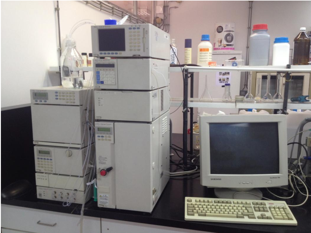
Slika 11. HPLC-uređaj za tekućinsku kromatografiju visoke učinkovitosti (Grubišić, 2017).
