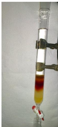
Slika 10. Kromatografska kolona na stupcu od silika gela pri pročišćavanju N1-ferocenoil uracila
