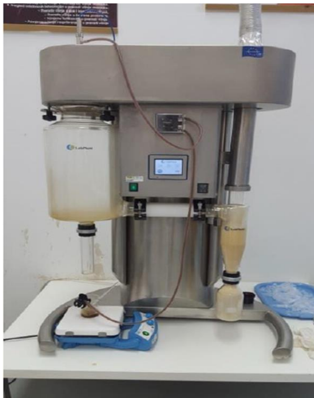
Slika 6. Uređaj za sušenje raspršivanjem (vlastita fotografija)
