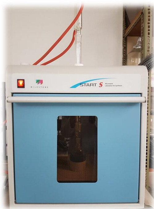
Slika 7. Uređaj za mikrovalnu ekstrakciju, mikrovalni reaktor (MILESTONE, START S Microwave Labstation for Synthesis) (vlastita fotografija)
