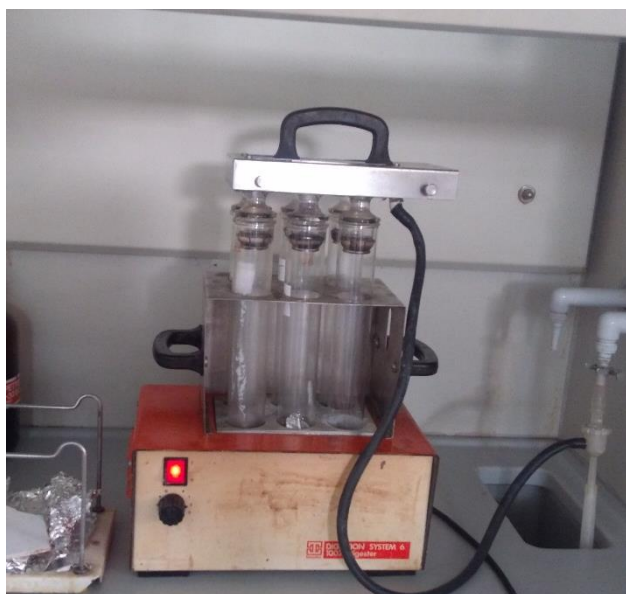
Slika 4. Prikaz Kjeltrec kiveta s uzorcima u bloku za spaljivanje (vlastita fotografija)
