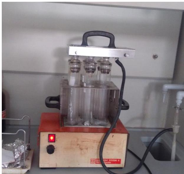
Slika 4. Prikaz Kjeltec kiveta s uzorcima u bloku za spaljivanje (vlastita fotografija)
