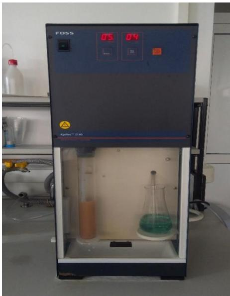
**Slika 5.** Prikaz destilacije metodom po Kjeldalhu (vlastita fotografija)
