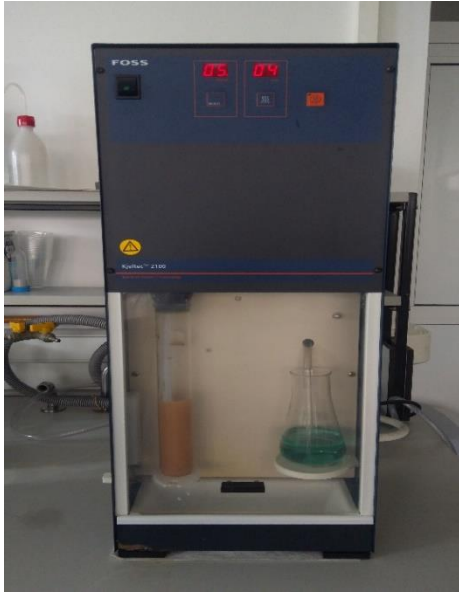
Slika 5. Prikaz destilacije metodom po Kjeldalhu (vlastita fotografija)
