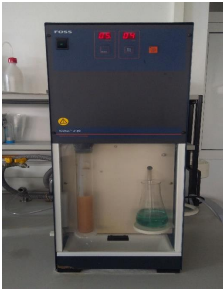
Slika 5. Prikaz destilacije metodom po Kjeldalhu (vlastita fotografija)
