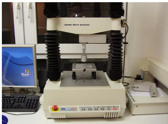
Slika 4. Stable Micro Systems Texture Analyser TA.HD.plus (Laboratorij za tehnološke operacije, 2008)
