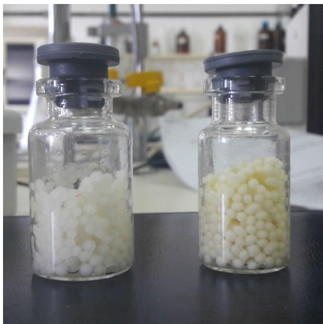
Slika 3. Prikaz bakterijskih stanica mikroinkapsuliranih u alginatu
