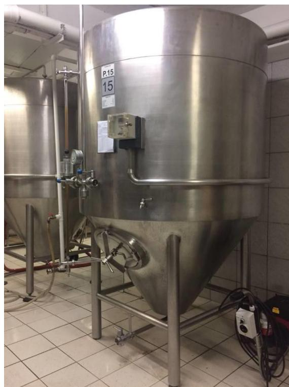
**Slika 5.** Fermentacijski tank pivovare Medvedgrad
