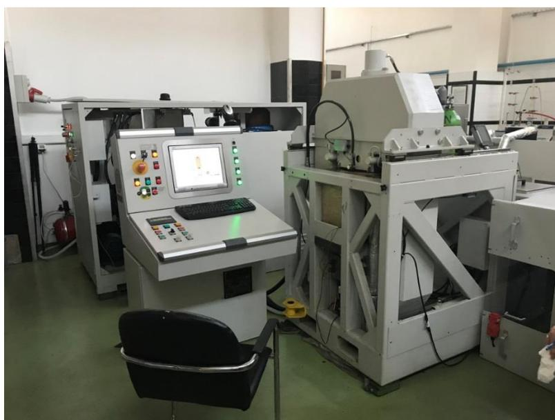
Slika 6. Uređaj za tretman visokim hidrostatskim tlakom (HHP).
