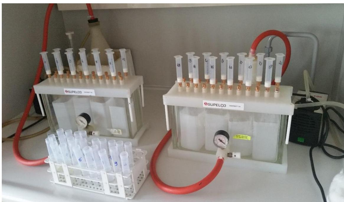
Slika 5. Pročišćavanje uzoraka na SPE kolonama Oasis PRiME HLB (vlastita fotografija)
