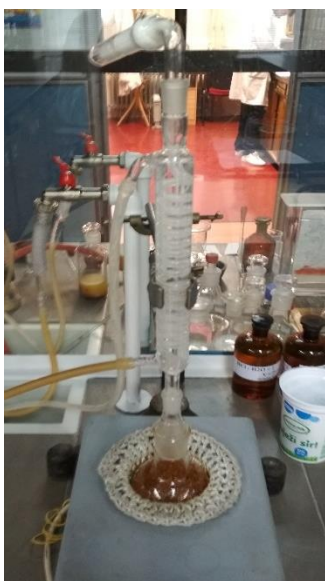
Slika 8. Korištena aparatura za refluksiranje
