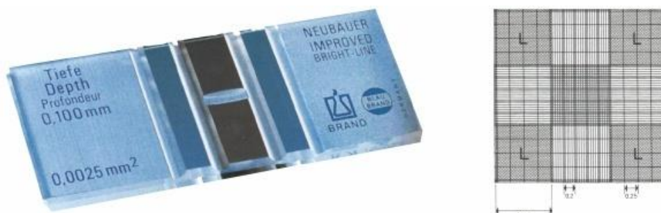
Slika 3. Neubaerova komorica za brojanje stanica (Anonymous 1, 2019)
