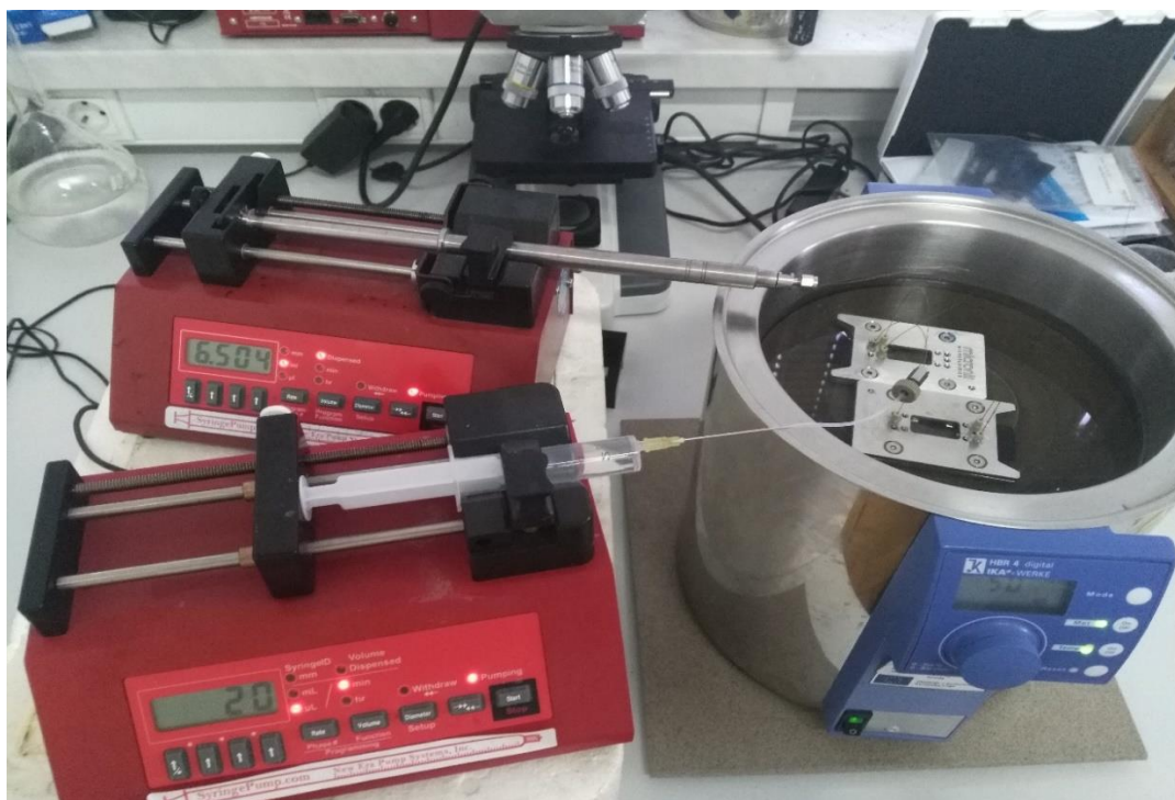
Slika 7. Vlastita fotografija aparature korištene za provedbu procesa ekstrakcije u mikroekstraktoru
