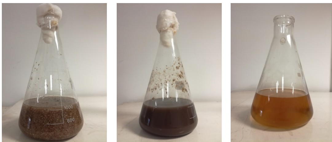
Slika 7. Usitnjena predobrađena pšenična slama u 60 mM natrij-acetatnom puferu s dodanim enzimom: (lijevo) prije stavljanja na odgovarajuću temperaturu reakcije; (sredina) nakon 48 sati hidrolize; (desno) filtrat dobiven nakon filtracije sadržaja tikvice kroz Büchenrov lijevjak.
