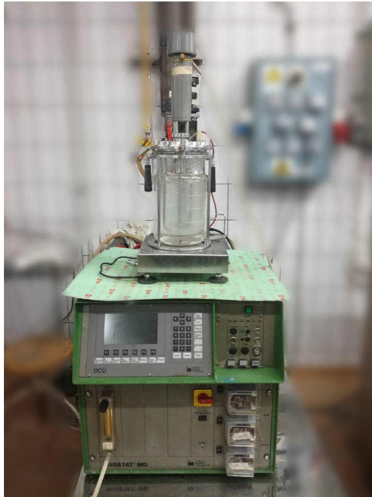
Slika 5. Bioreaktor s miješalom (B. Braun Biotech International, Berlin, Njemačka) koji je u ovom radu korišten za proizvodnju mliječne kiseline.
