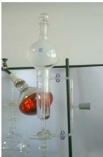
Slika 7. Generator pare i sustav za dušik
