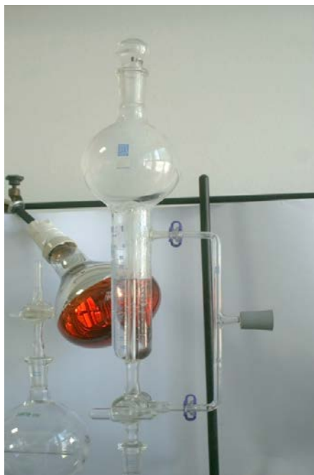
Slika 7. Generator pare i sustav za dušik
