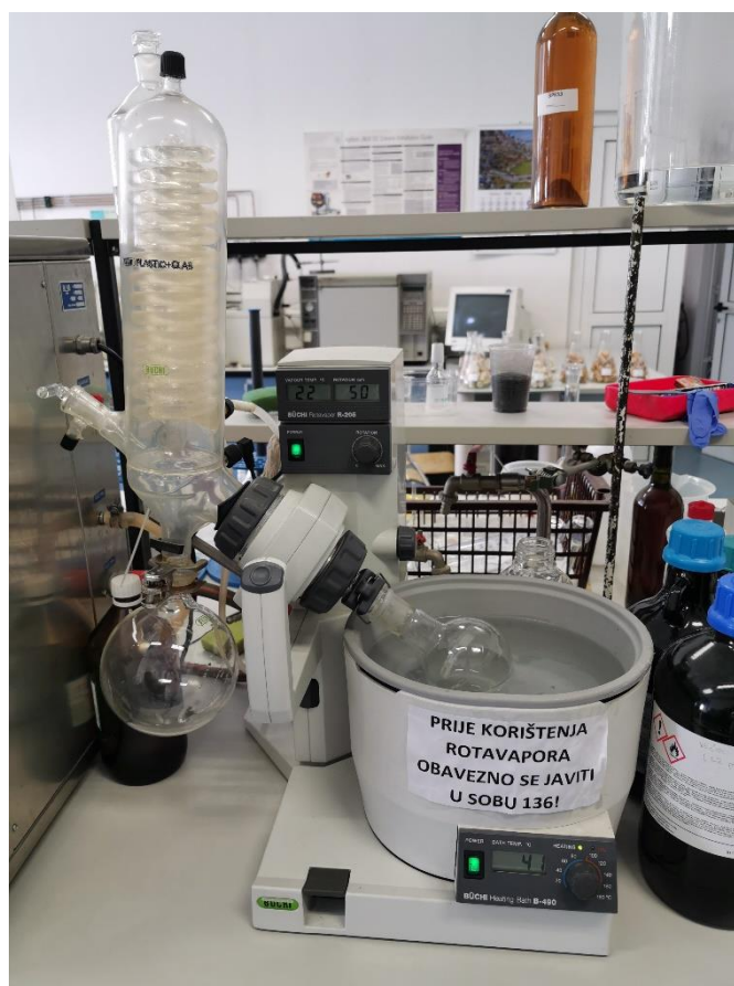
Slika 8. Rotavapor (B-490, BÜCHI, Flawil, Švicarska) (vlastita fotografija)
