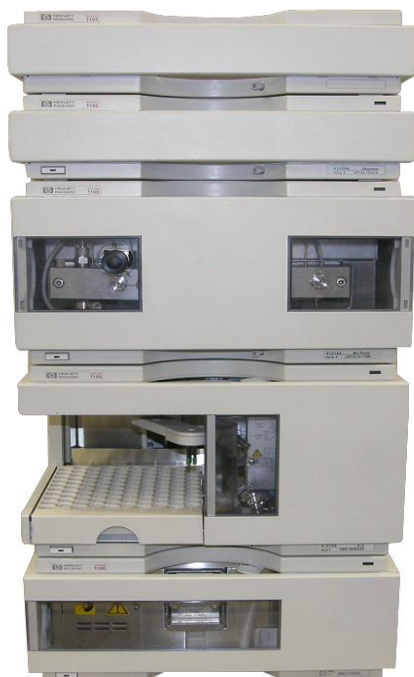
Slika 10. Uređaj za HPLC analizu, 1100 Seria (Anonymous 3)
