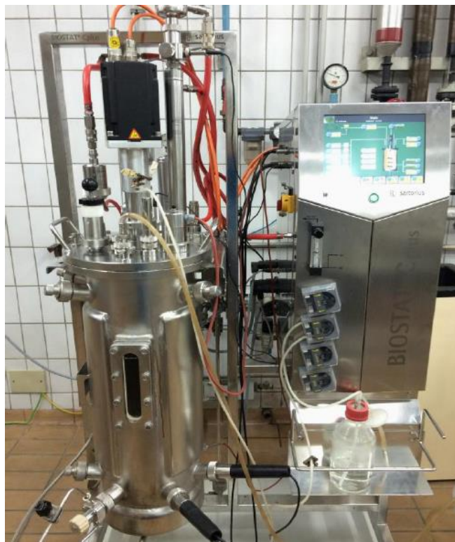
Slika 4. Bioreaktor s miješalom Biostat Cplus (Sartorius BBI Systems GmbH, Njemačka)
