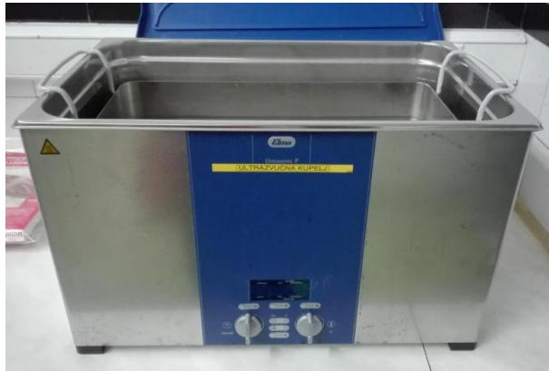
**Slika 6.** Ultrazvučna kupelj Elmasonic P 300 H (Elma, Singen, Njemačka). Ova je ultrazvučna kupelj korištena u eksperimentima onako kako je to opisano u poglavljju 3.2.5.1.
