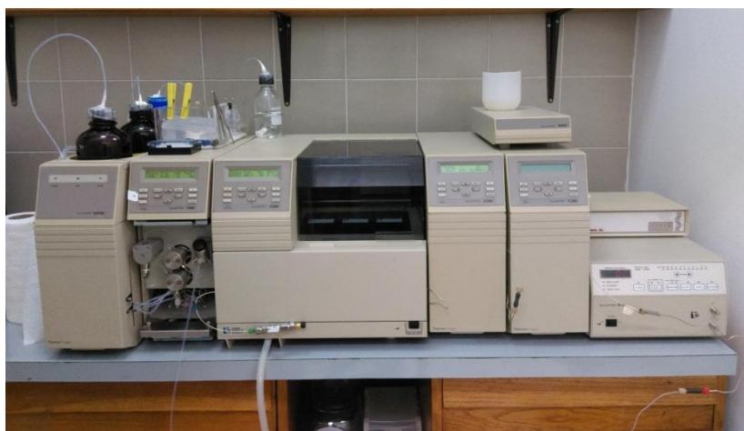
**Slika 7.** Sustav za tekućinsku kromatografiju visoke učinkovitosti (HPLC).
