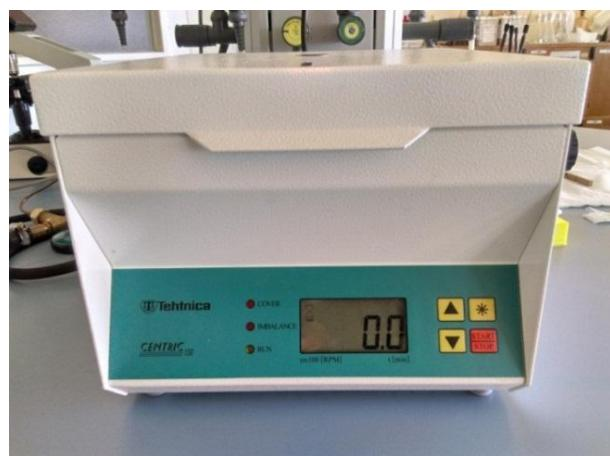
**Slika 4.** Centrifuga Centric 150 (Tehtnica, Železniki, Slovenija) za izdvajanje supernatanta od biomase bakterijskog soja iz uzoraka izdvojenih tijekom uzgoja *L. mesenteroides* LMG 7954 kao i za izdvajanje supernatanta od taloga tijekom pripreme uzoraka za analizu HPLC metodom. Izuzeti uzorci centrifugirani su kroz 5 min pri  $13\ 000 \cdot g$ . Izdvojeni supernatant spremljen je pri  $-20^{\circ}\text{C}$  do analize HPLC metodom.
