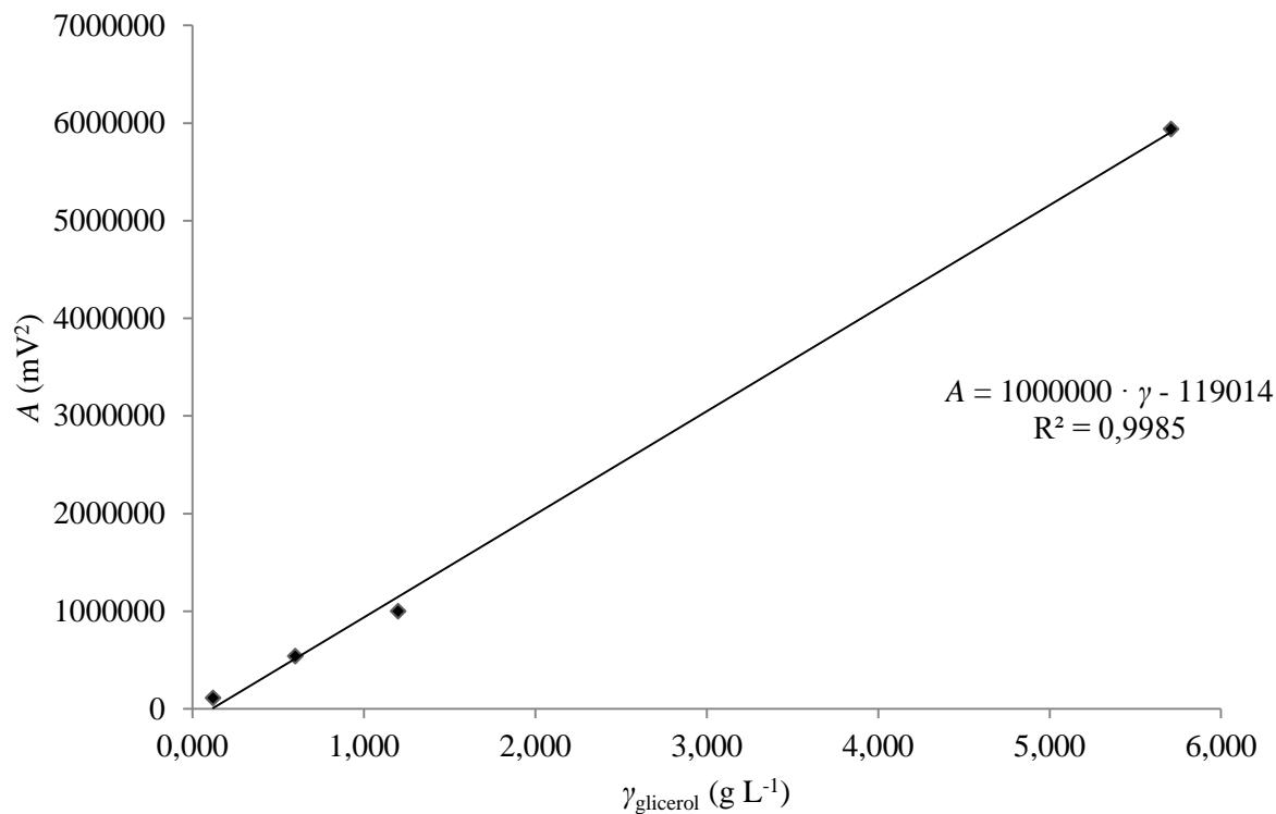
**Slika 36.** Baždarni dijagram ovisnosti površine pika ( $A$ , mV<sup>2</sup>) glicerola ( $t_R = 7,37$  min) o njegovoj koncentraciji ( $\gamma_{\text{glicerol}}$ , g L<sup>-1</sup>) u otopini.
