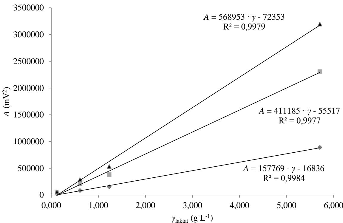
**Slika 35.** Baždarni dijagram ovisnosti površine pika ( $A$ , mV<sup>2</sup>) laktata (L-enantiomer,  $t_R = 5,69$  min, ♦; D-enantiomer,  $t_R = 7,20$  min, ■; ukupni laktat, ▲) o njegovoj koncentraciji ( $\gamma_{\text{laktat}}$ , g L<sup>-1</sup>) u otopini.
