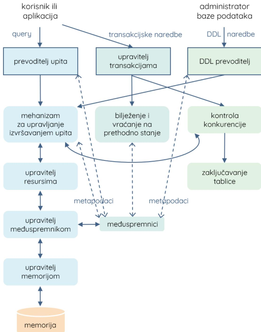
**Prilog 2.1.** Shematski prikaz komponenti sustava za upravljanje bazama podataka (Prilagođeno prema Ullman i Widom, 2007).
