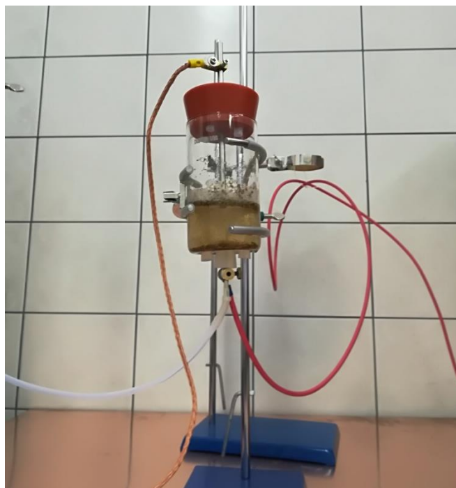
Slika 5. Visokonaponsko električno pražnjenje u suspenziji
