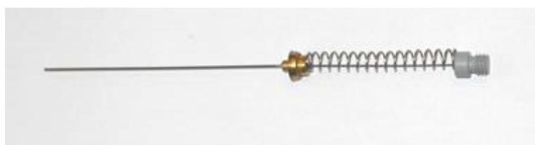
Slika 9. Vlakna s ovojnicama DVB/CAR/PDMS (sivo vlakno)
