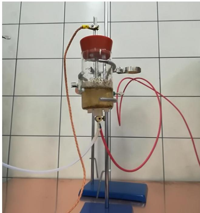
Slika 5. Visokonaponsko električno pražnjenje u suspenziji
