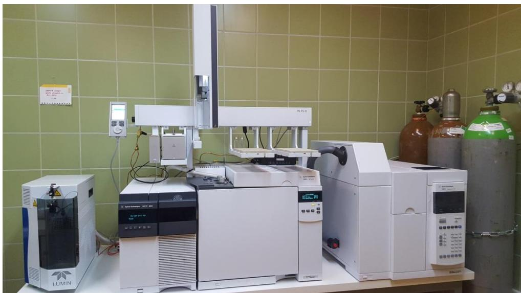
Slika 10. Vezani sustav plinska kromatografija-spektrometrija masa (GC-MS)
