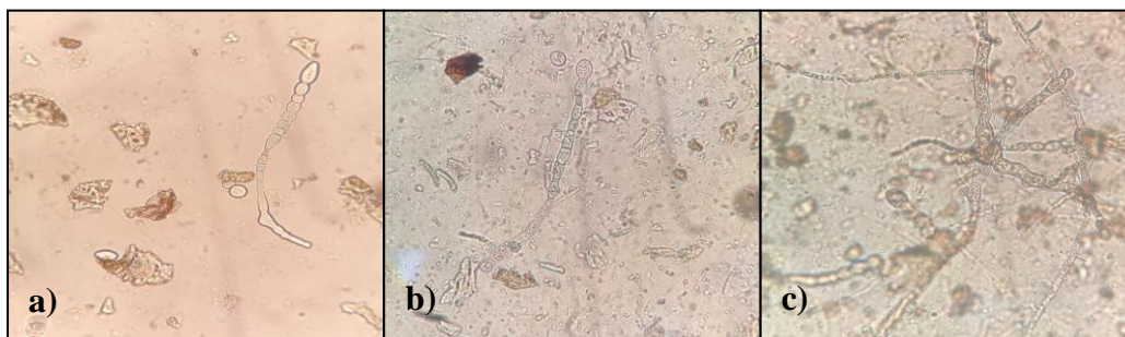
Slika 25. Rast plijesni M. indicus u acetatnom puferu na 40 \text{ }^\circ\text{C} uz 4 % (vol/vol) Cellulase Blend tijekom 24 sata uzgoja: a) 0 h; b) 8 h; c) 24 h
