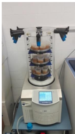
Slika 10. Liofilizacija ekstrakta lista masline (Vlastita fotografija)
