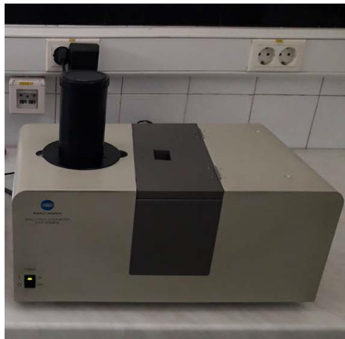
Slika 9. Spektrofotometar CM-3500d
