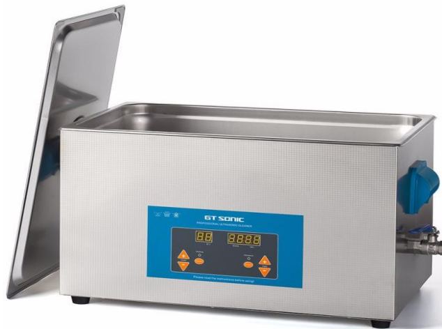
Slika 8. Ultrazvučna kupelj (Anonymus 5)
