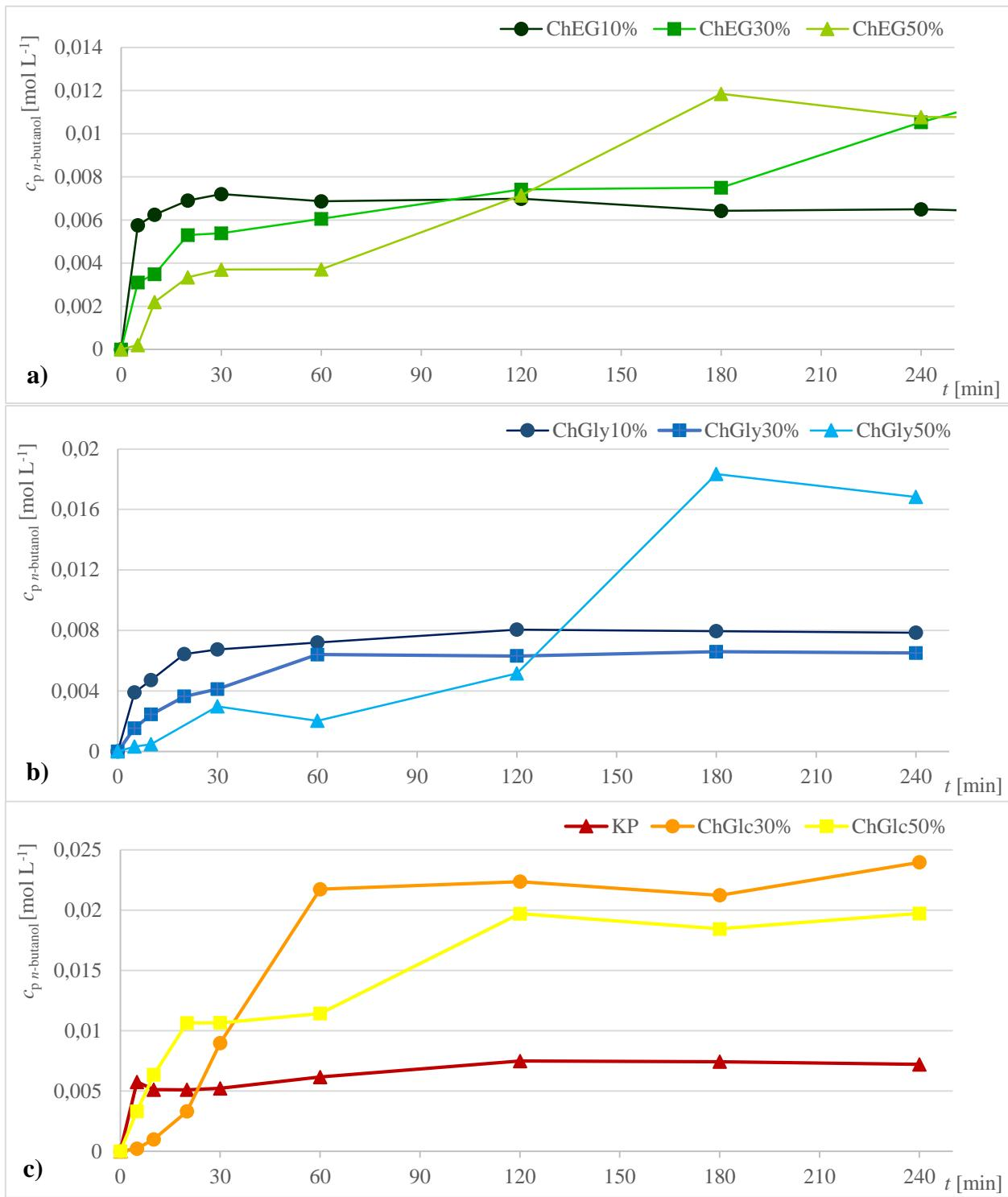
Slika 9. Tijek imLip katalizirane reakcije hidrolize butil-etanoata prikazan kroz nastanak produkta butan-1-ola ( $c_p$ ) u a) kolin-klorid:etan-1,2-diolu (ChEG), b) kolin-klorid:glicerolu (ChGly), c) kalij-fosfatnom puferu (KP) i kolin-klorid:glukozi (ChGlc). Reakcijski uvjeti: 5,0 mg imLip, 0,1 mol L<sup>-1</sup> butil-etanoata, 25 °C, 240 minuta.
