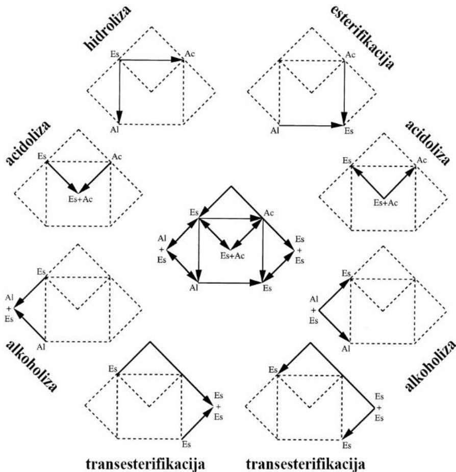
Slika 2. Pregled reakcija kataliziranih lipazama. Reaktanti su shematski pozicionirani na početku, a produkti na kraju streljica. Kratice: ester (Es), alkohol (Al), kiselina (Ac) (Paiva i sur., 2000).
