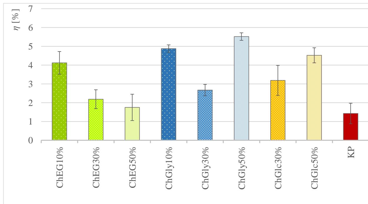
Slika 14. Iskorištenje ( $\eta$ ) sLLip katalizirane reakcije hidrolize butil-etanoata u različitim otapalima. Reakcijski uvjeti:  $75 \mu\text{L}$  sLLip [ $4 \text{ mg ml}^{-1}$ ],  $7,5 \mu\text{L}$  butil-etanoata [ $0,1 \text{ mol L}^{-1}$ ],  $25^\circ\text{C}$ , vrijeme: do uspostave ravnoteže reakcije. Kratice: kolin-klorid:etan-1,2-diol (ChEG), kolin-klorid:glicerol (ChGly), kalij-fosfatni pufer (KP) i kolin-klorid:glukoza (ChGlc).
