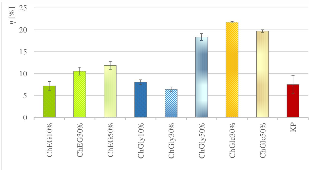
Slika 10. Iskorištenje ( $\eta$ ) imLip katalizirane reakcije hidrolize butil-etanoata u različitim otapalima. Reakcijski uvjeti: 5,0 mg imLip, 0,1 mol L<sup>-1</sup> butil-etanoata, 25 °C, vrijeme: do uspostave ravnoteže reakcije. Kratice: kolin-klorid:etan-1,2-diol (ChEG), kolin-klorid:glicerol (ChGly), kalij-fosfatni pufer (KP) i kolin-klorid:glukoza (ChGlc).
