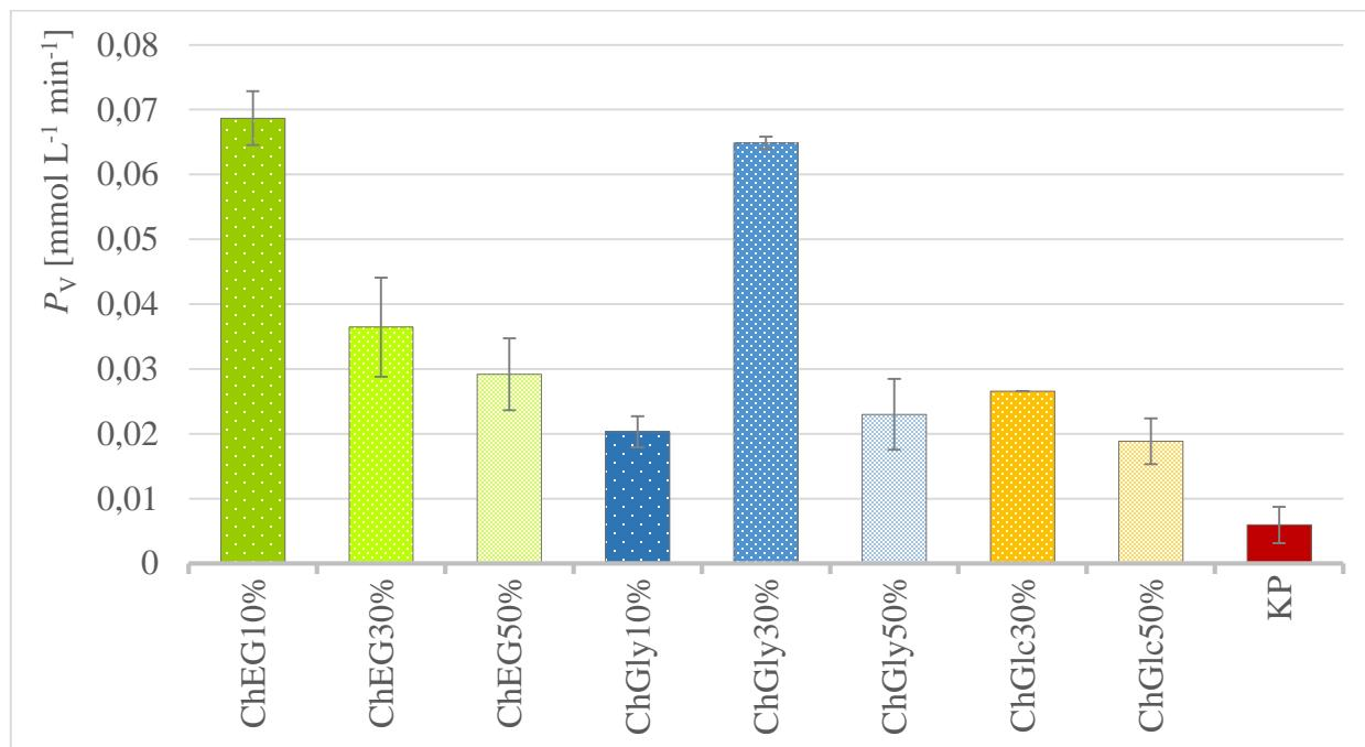
Slika 15. Volumetrijska produktivnost ( $P_v$ ) za slLip kataliziranu reakciju hidrolize butil-etanoata u različitim otapalima. Reakcijski uvjeti:  $75 \mu\text{L}$  slLip [ $4 \text{ mg ml}^{-1}$ ],  $7,5 \mu\text{L}$  butil-etanoata [ $0,1 \text{ mol L}^{-1}$ ],  $25^\circ\text{C}$ , vrijeme: do uspostave ravnoteže reakcije. Kratice: kolin-klorid:etan-1,2-diol (ChEG), kolin-klorid:glicerol (ChGly), kalij-fosfatni pufer (KP) i kolin-klorid:glukoza (ChGlc).
