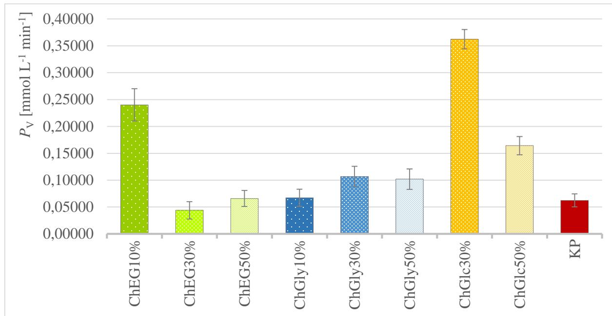
Slika 11. Volumetrijska produktivnost ( $P_V$ ) za imLip kataliziranu reakciju hidrolize butil-etanoata u različitim otapalima. Reakcijski uvjeti: 5,0 mg imLip, 0,1 mol L<sup>-1</sup> butil-etanoata, 25 °C, vrijeme: do uspostave ravnoteže reakcije. Kratice: kolin-klorid:etan-1,2-diol (ChEG), kolin-klorid:glicerol (ChGly), kalij-fosfatni pufer (KP) i kolin-klorid:glukoza (ChGlc).
