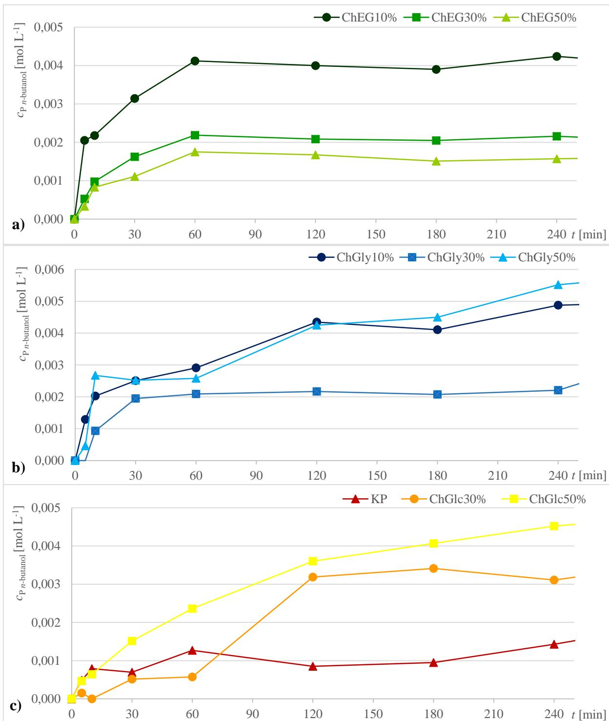
Slika 13. Tijek slLip katalizirane reakcije hidrolize butil-etanoata prikazan kroz nastanak produkta butan-1-ola u a) kolin-klorid:etan-1,2-diolu (ChEG), b) kolin-klorid:glicerolu (ChGly), c) kalij-fosfatnom puferu (KP) i kolin-klorid:glukozi (ChGlc). Reakcijski uvjeti: 75  $\mu\text{L}$  slLip [ $4 \text{ mg ml}^{-1}$ ], 7,5  $\mu\text{L}$  butil-etanoata [ $0,1 \text{ mol L}^{-1}$ ], 25 °C, 240 minuta.
