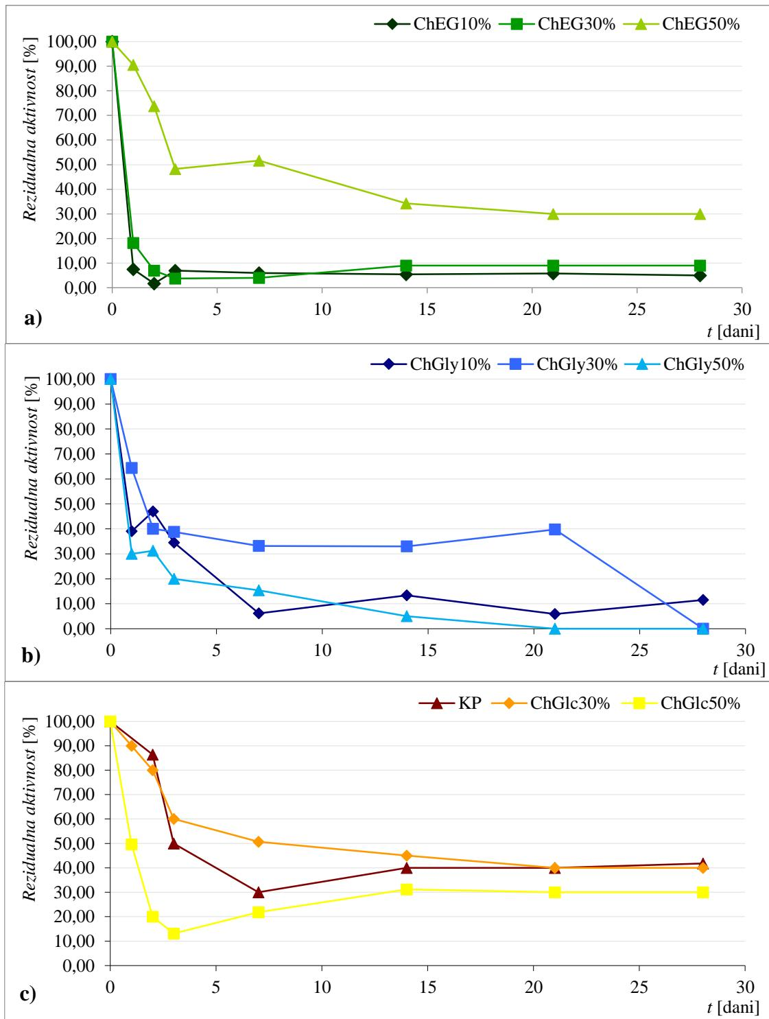
Slika 16. Rezidualna aktivnost slLip u puferu i NADES-ima sa različitim udjelima vode (10, 30 i 50 % (v/v)) u ovisnosti o vremenu inkubacije. a) kolin-klorid:etan-1,2-diol (ChEG), b) kolin-klorid:glicerol (ChGly), a) kalij-fosfatni pufer (KP) i kolin-klorid:glukoza (ChGlc). Reakcijski uvjeti: 75  $\mu$ L slLip [ $4 \text{ mg ml}^{-1}$ ], 7,5  $\mu$ L butil-etanoata [ $0,1 \text{ mol L}^{-1}$ ], 25 °C, 28 dana.
