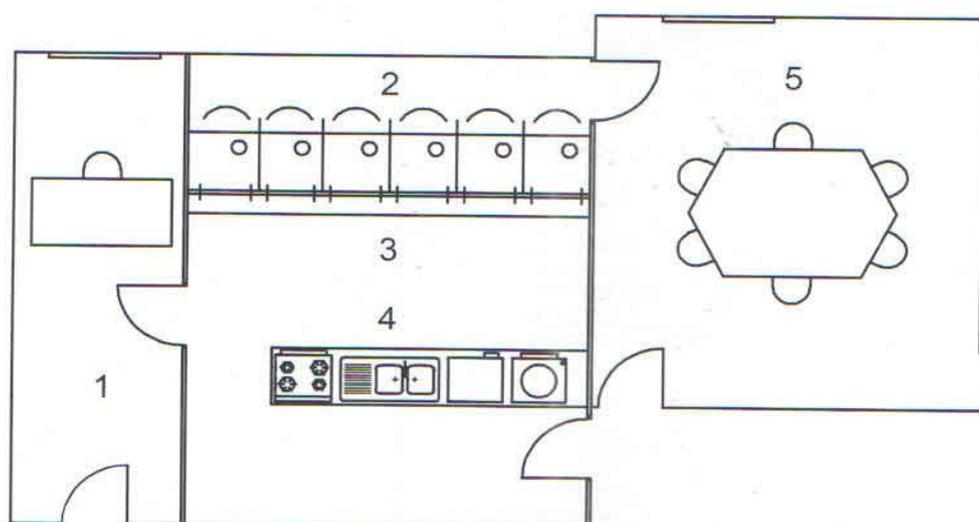
Slika 1. Tlocrt prostorije za provođenje senzorske analize (ISO 8589:2007)
