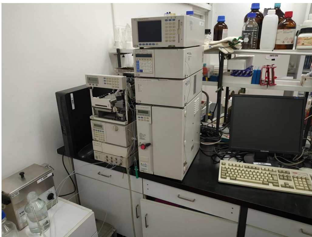
Slika 11. HPLC- Shimadzu CLASS-VP LC-10A VP sustav (Japan).
