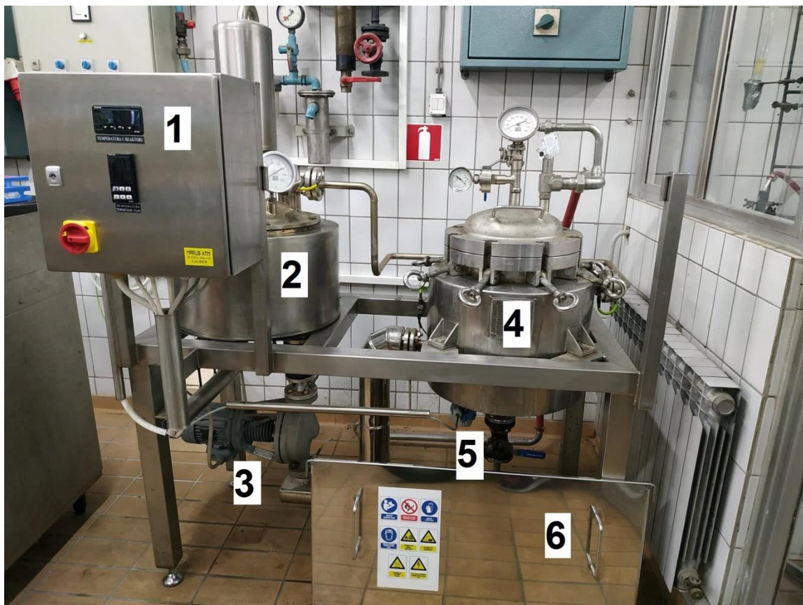
Slika 10. Visokotlačni bioreaktor (1-kontrolna jedinica, 2-posuda sa grijačima i termičkim uljem, 3-pumpa, 4-reaktor za predobradu sirovine, 5-ventil za ispust tekućeg dijela, 6-zaštitna jedinica).
