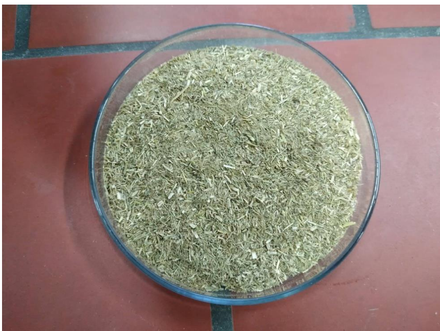
Slika 8. Suha otpadna trava usitnjena na mlinu čekičaru.
