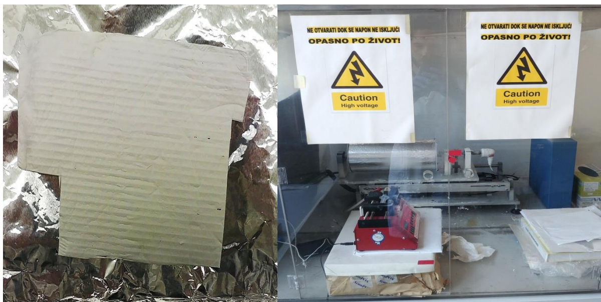
Slika 2. PCL dobiven elektroispredanjem (lijevo) i uređaj za elektroispredanje NT-ESS-300 (desno), Tekstilno-tehnološki fakultet (Ivančić, 2018).
