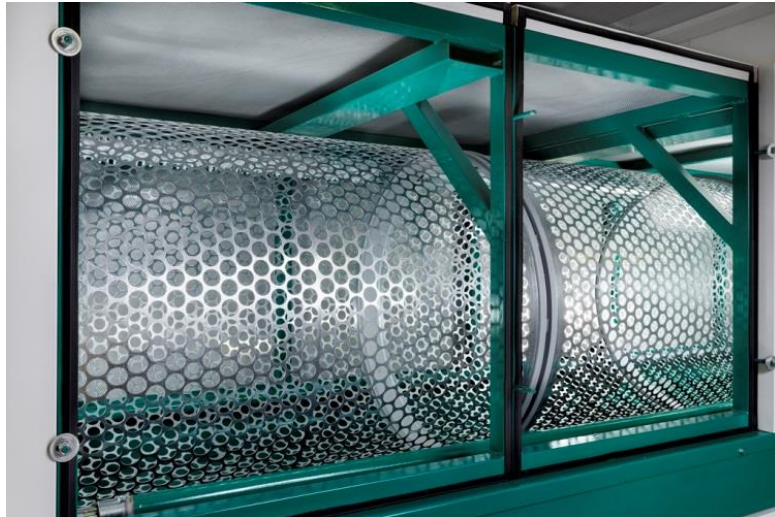
Slika 9. Prikaz valjaka za kalibraciju (Anonymous 6, 2018)
