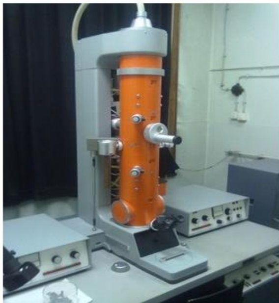
Slika 6. Transmisijski elektronski mikroskop (vlastita fotografija)
