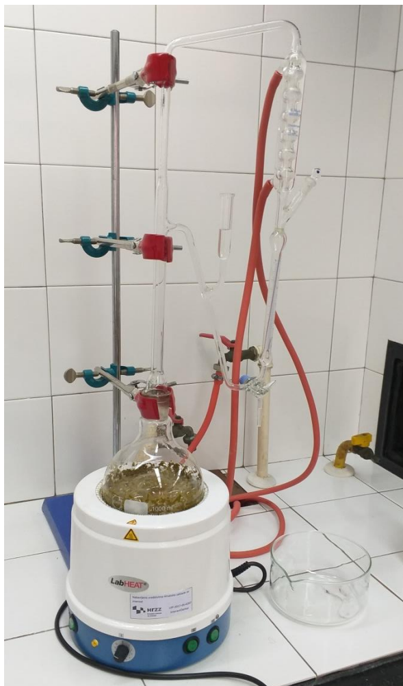
Slika 11. Vodena destilacija u aparaturi po Clavengeru (vlastita fotografija)
