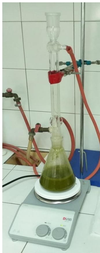
Slika 9. Predtretman enzimom ksilanazom na vodenoj kupelji (vlastita fotografija)
