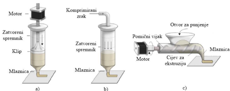
Slika 2. Mehanizmi ekstruzije u 3D printanju hrane (Sun i sur., 2018)
