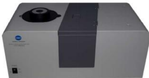
Slika 13. Kolorimetar CM3500d (Konica Minolta, Japan) (Anonymus 7, 2020)
