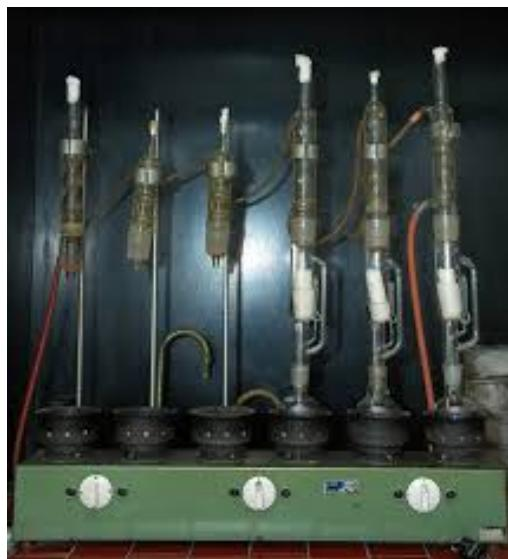
Slika 13. Aparatura za ekstrakciju masti po Soxhletu (Anonymous 7, 2020)
