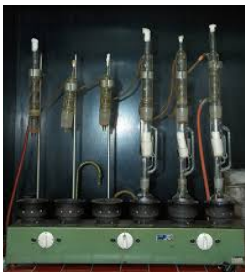
Slika 13. Aparatura za ekstrakciju masti po Soxhletu (Anonymous 7, 2020)
