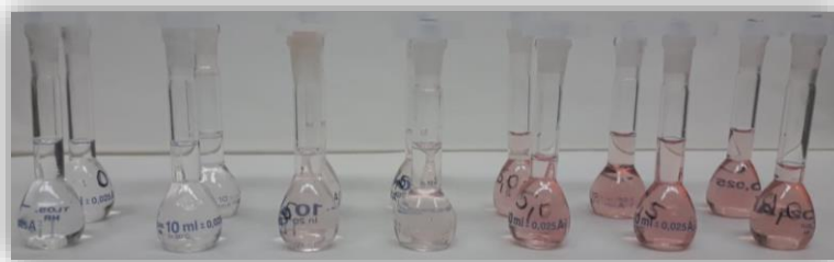
Slika 6. Standardne otopine rutina korištene za izradu baždarnog dijagrama.
