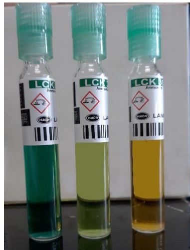
Slika 5. Određivanje amonijevih iona s razvojem obojenja otopine (vlastita fotografija)
