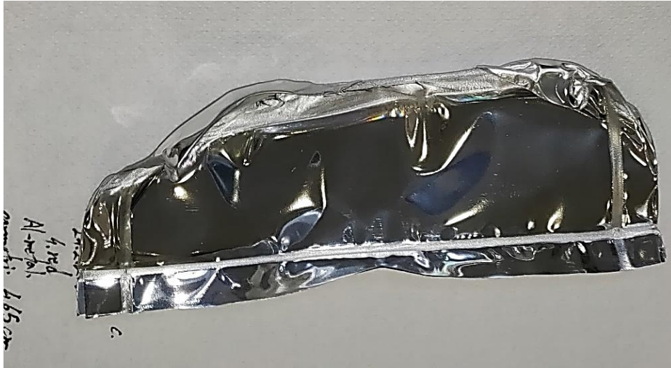
Slika 3. Primjer oštećene PPmet/PE ambalaže nakon tretmana udaljenost=4,65 cm i vrijeme=15 sec (vlastita slika)
