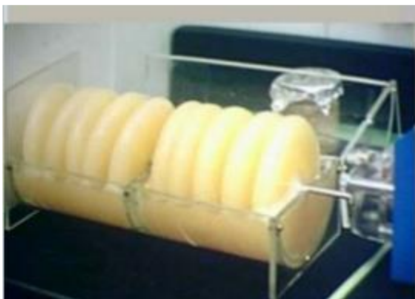
Slika 9. Uzgoj BNC u reaktoru s rotirajućim diskovima (Lee i sur., 2014)
