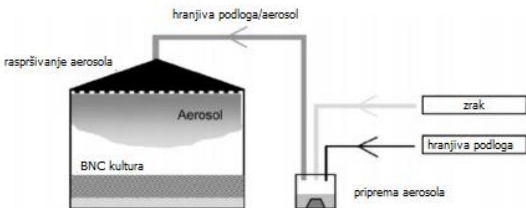
**Slika 10.** Uzgoj BNC u aerosol bioreaktoru (Lee i sur., 2014)
